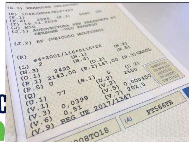
La lettera "V" è riservata alle emissioni dei gas di scarico, "V.3" per gli ossidi di azoto, "V.5" per il particolato nei motori diesel, "V.7" il CO<sub>2</sub>, "V.8" indica invece il consumo medio di carburante nei test su ciclo misto o combinato espresso in litri per 100 Km.
